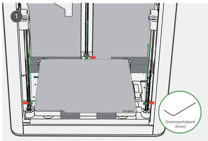
Entfernen Sie die drei Schrauben mit einem Innensechskantschlüssel 2mm, um das Druckbett zu lösen.
