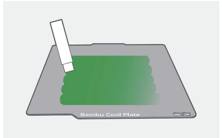
Tragen Sie eine dünne Schicht Kleber auf die Bauplatte auf.
