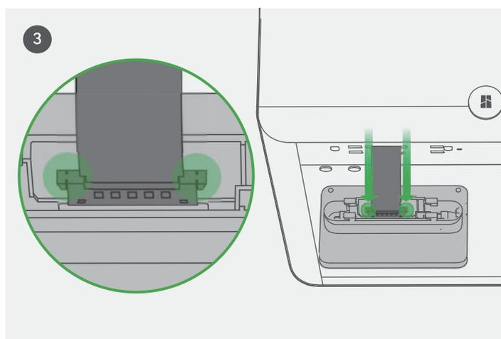
Stecken Sie das Flexkabel (FPC) in den Anschluss, indem Sie wie abgebildet auf die Verriegelung drücken.
