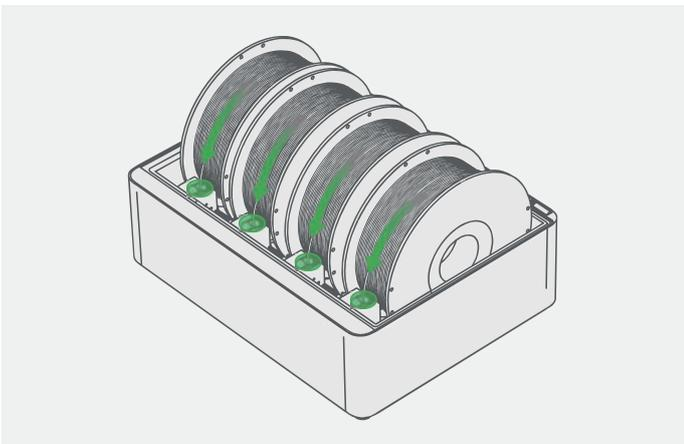
Legen Sie mindestens eine Spule Bambu-Filament in das AMS ein. Schalten Sie den Strom ein, um den Drucker und das AMS zu starten. Führen Sie das Filament in den Filamenteinlass ein. Das Filament wird automatisch vorgeladen, wenn es erkannt wird.
