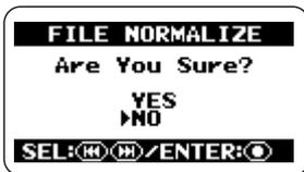
Um mit dem Normalisieren fortzufahren, setzen Sie den Cursor auf „YES“ und drücken die Taste **●** (REC). Abschließend kehrt das Display zu Schritt 3 zurück.
