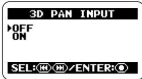
Setzen Sie den Cursor im entsprechenden Screen auf ON und drücken Sie die **[C]** (REC)-Taste, um das entsprechende Signal abzuhören. Abschließend wird wieder das Menü 3D PAN im Display angezeigt.
