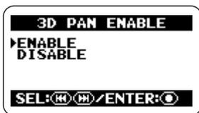
Um die Einstellungen für das 3D-Panning zu verwenden, setzen Sie den Cursor auf „ENABLE“ und drücken die Taste **(O)** (REC). Die Einstellung wird übernommen und das Display kehrt zum vorherigen Schritt zurück.
